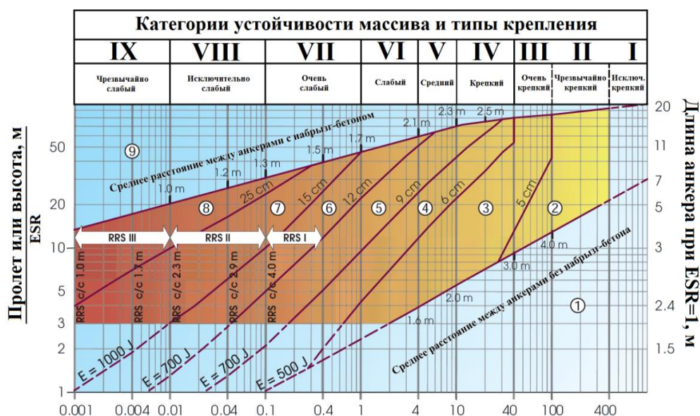
Рисунок 1. - Диаграмма выбора типа и параметров крепи в зависимости от Q-рейтинга.
