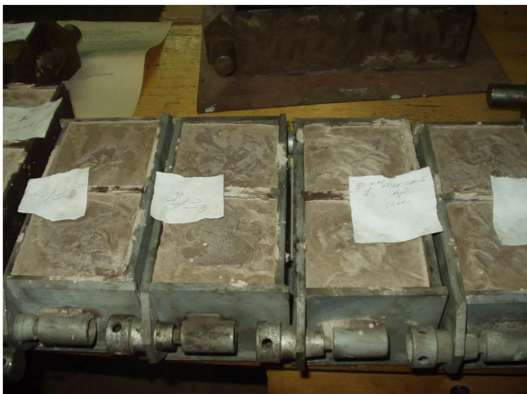
Рисунок 2.11- Формы, заполненные смесью
