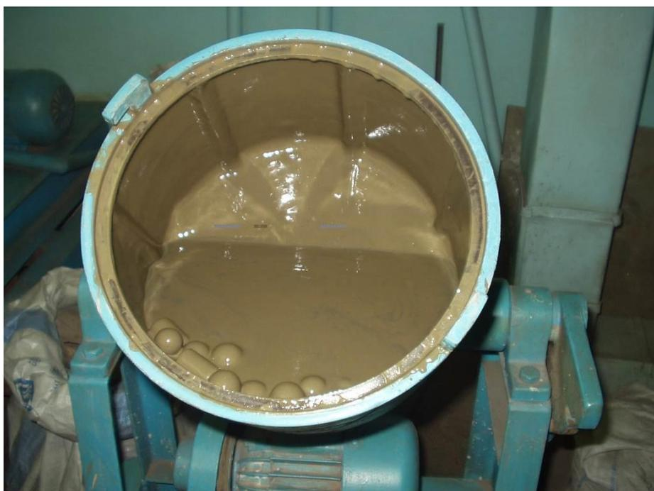
Рисунок 2.8 - Готовая закладочная смесь
