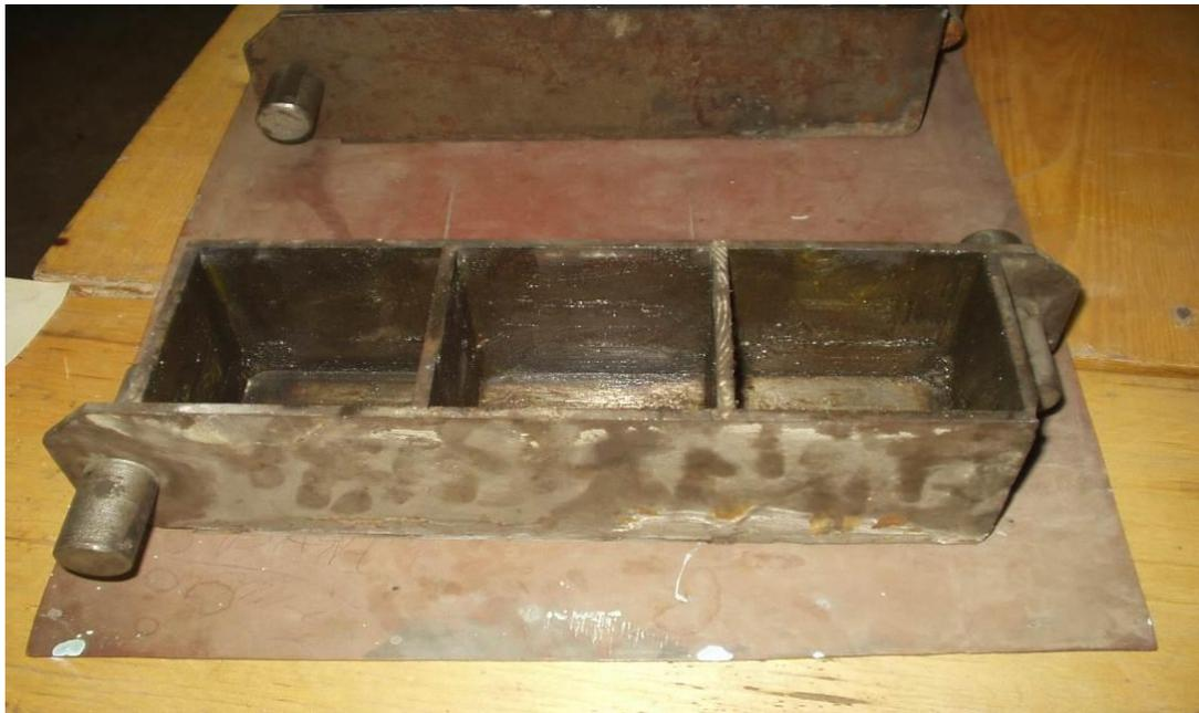
Рисунок 2.10- Формы для изготовления образцов
