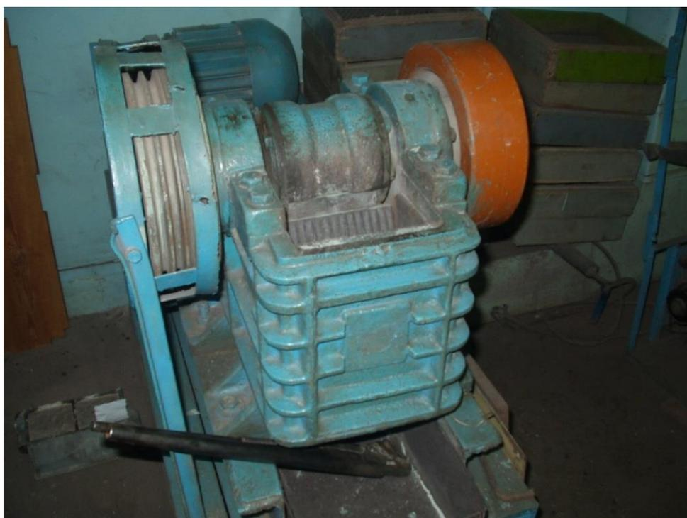
Рисунок 2.9 - Лабораторная щековая дробилка
