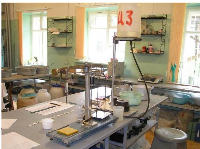
Рисунок 2.15 - Прибор Ребиндера-Вейлера
