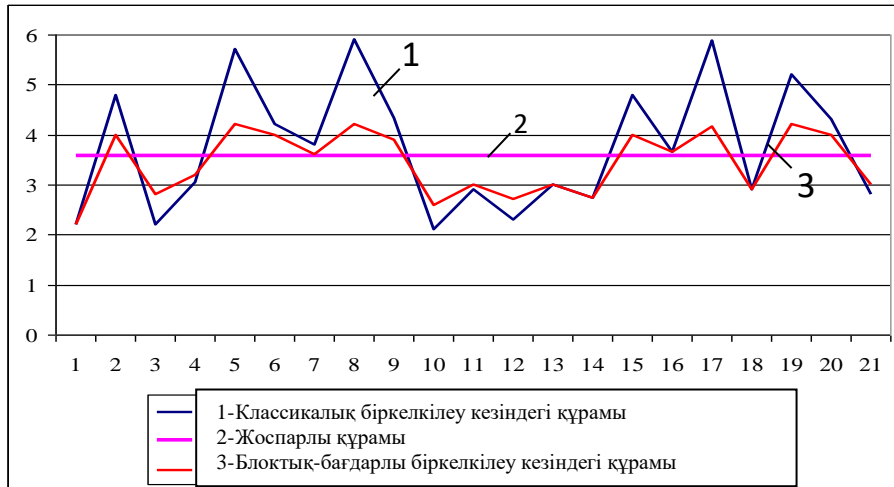
11-сурет. Қабатты әртүрлі блоктық-секторлық қалыптастыру кезіндегі пайдалы компоненттердің нақты құрамының ауытқулары.
