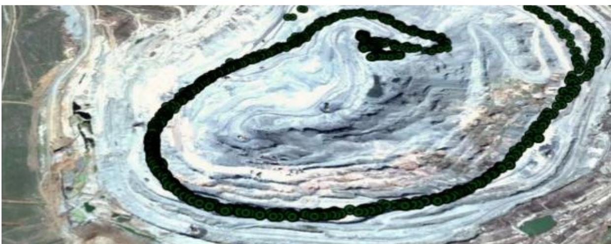
Б. Трек автосамосвала с девятью запущенными узлами связи
