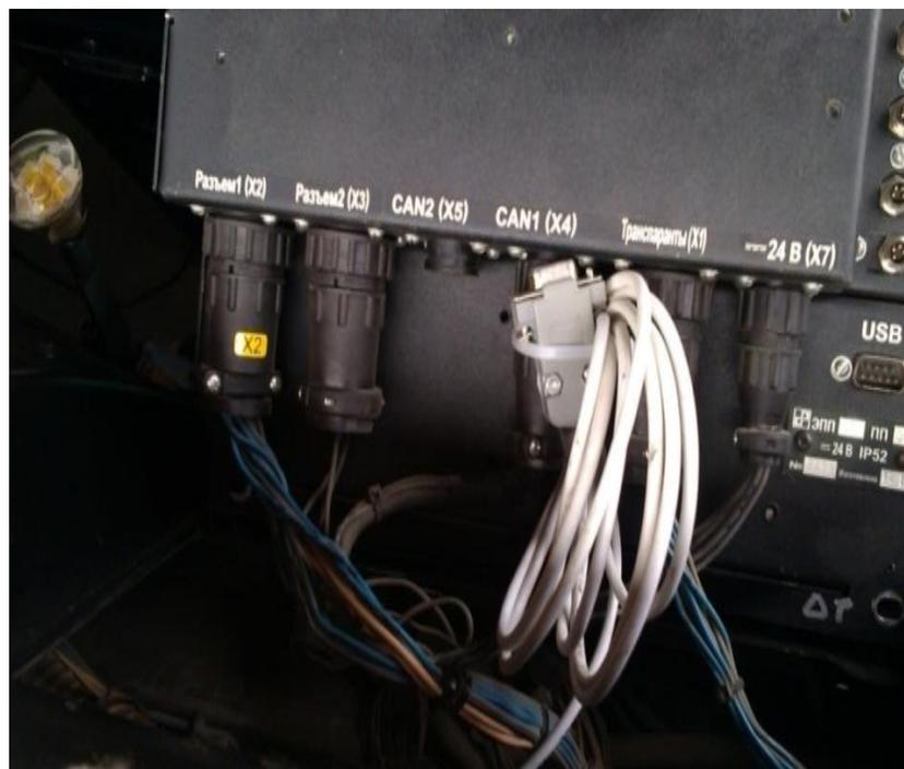
г – место подключение к CAN шине автосамосвала
