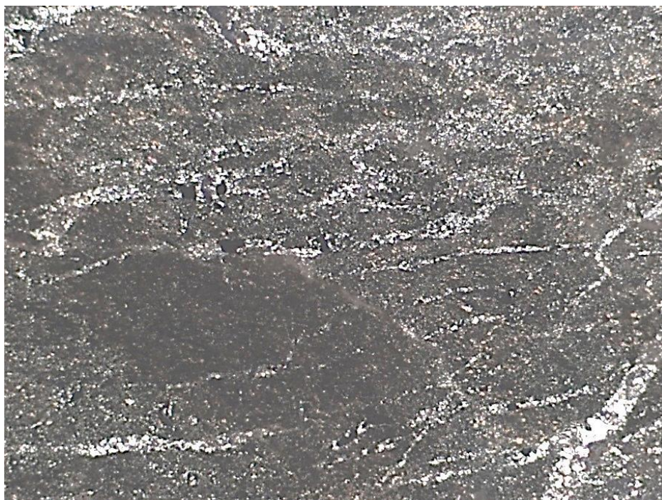
Сурет 2.2 - Серицитті-кремнийлі-көміртекті тақтатас, шамамен 100 x ұлғайтылған, айқас николді
