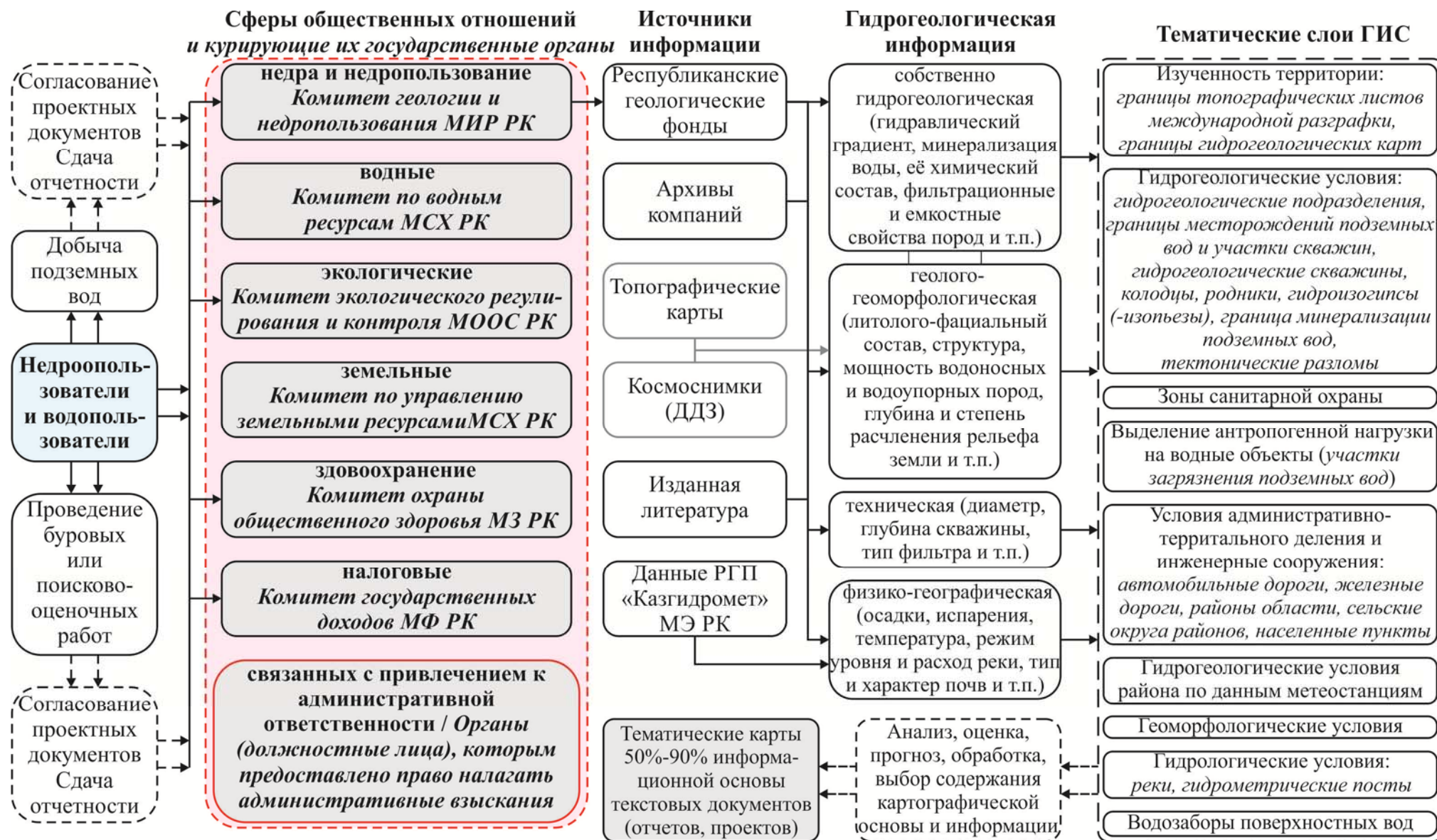
Рисунок 4.9 – Функциональная структура единой ГИС гидрогеологического значения
