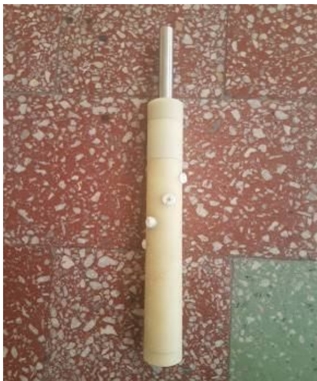
Фотосурет 3.2 – Сүзгілердің декольматациялау бойынша жинақталған түріндегі құрылғы
