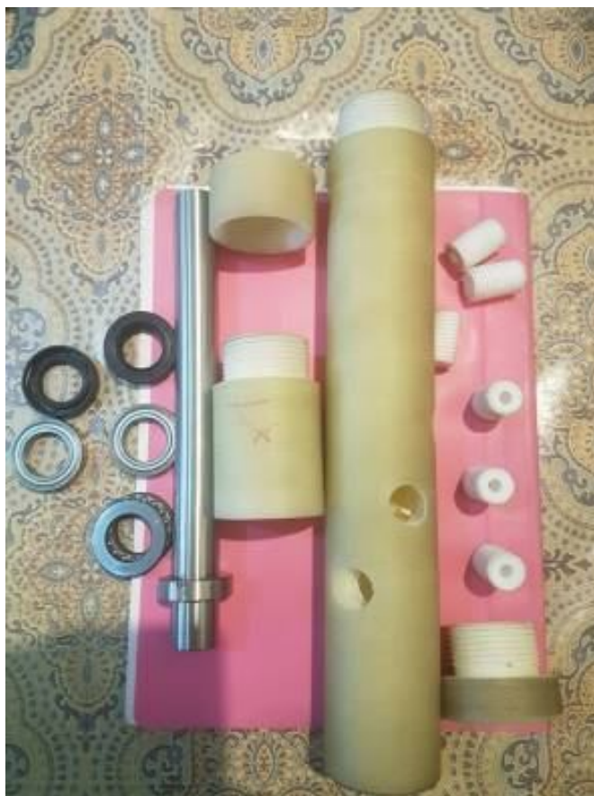
Фотосурет 3.1 – Сүзгілерді декольматациялау бойынша бөлшектелген құрылғы
