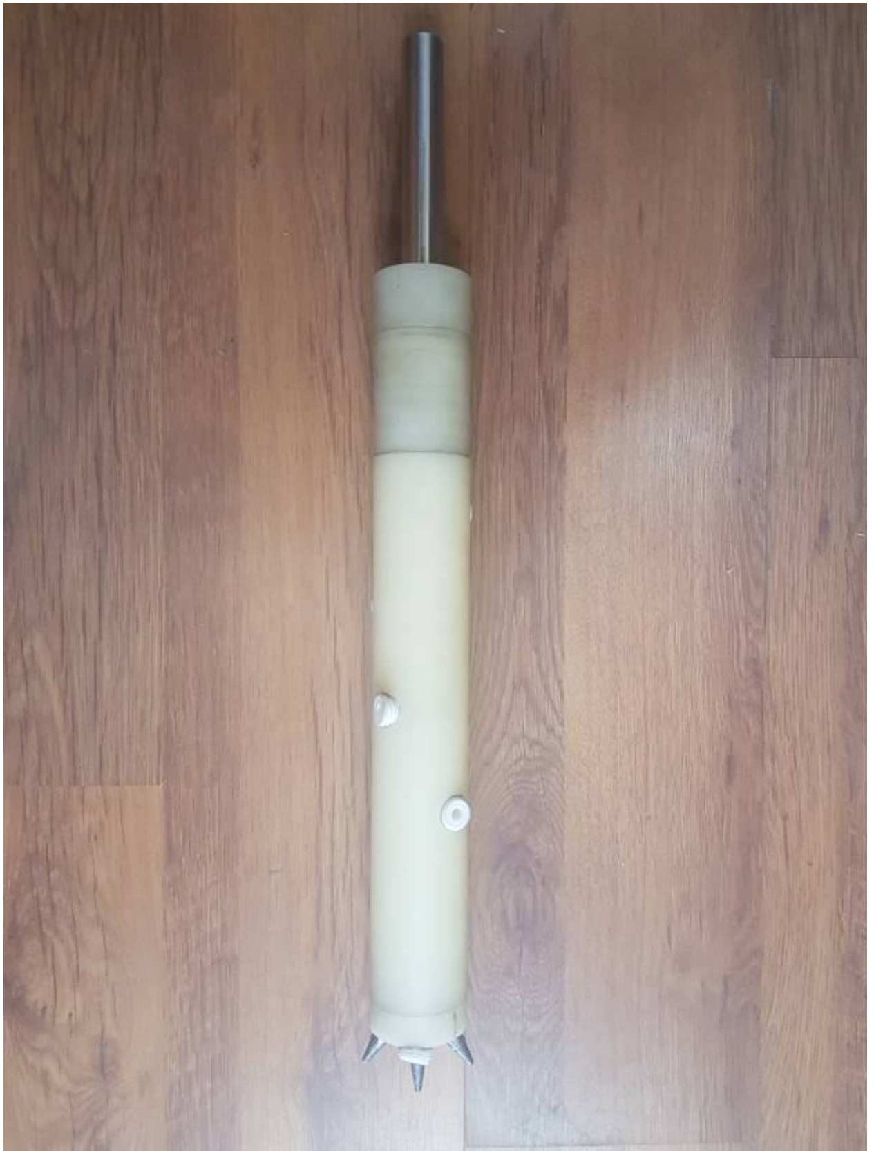
Фотосурет 3.3 – Құрылғының жинақталған сүзгілерді декольматациялау бойынша екінші түрленімі
