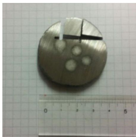
Сурет 4.5 - Құрамы 3D-әдісімен зерттелген балқытылып алынған болат үлгісі
