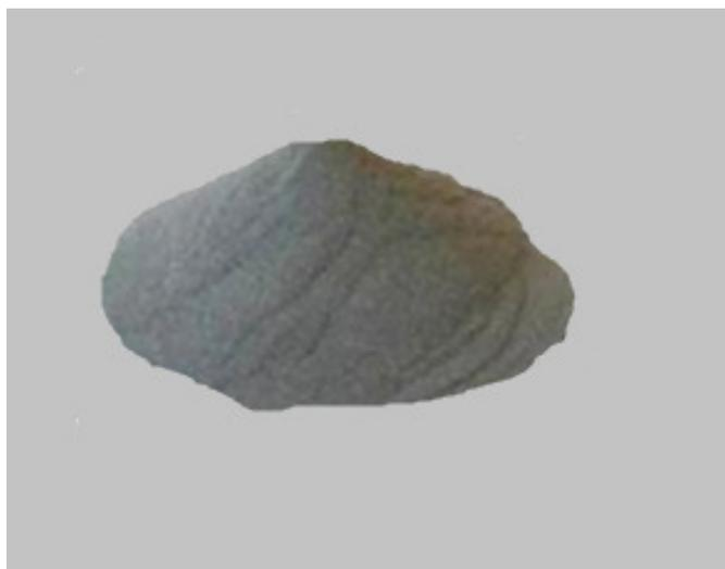
Рисунок 37 – Внешний вид катодного осадка, получаемого при электрохимической переработке жаропрочного сплава ЖС32-ВИ
