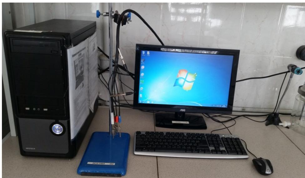
Рисунок 13 – Общий вид потенциостата марки PCI4/750/ZRA
