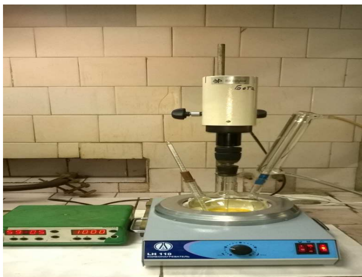
Рисунок 23 – Установка для кислотного выщелачивания
