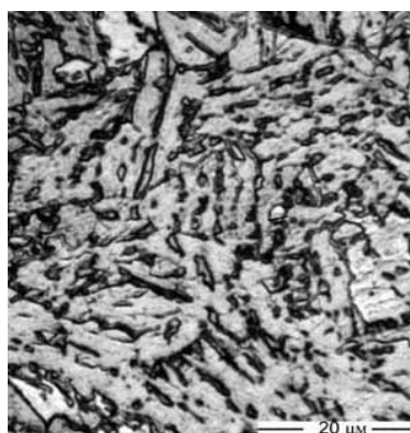
Рисунок 13 – Игольчатый бейнит: сталь 05Г2МФБ, аустенитизация при 1000°C, охлаждение 10 град /с (а); ПЭМ (б)
