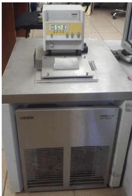
Рисунок 27 – Климатическая камера LAUDA PROLINE RP 890
