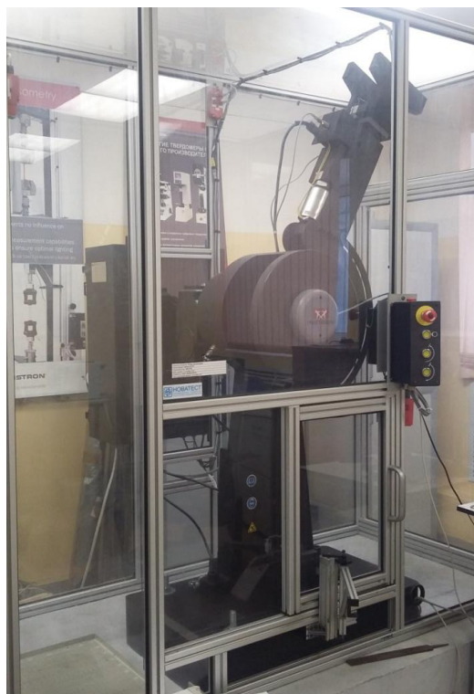
Рисунок 26 – копер маятниковый Instron SI-1M
