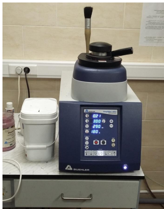
Рисунок 21 – Прессовальный аппарат SimpliMet XPS 1 (Buehler)
