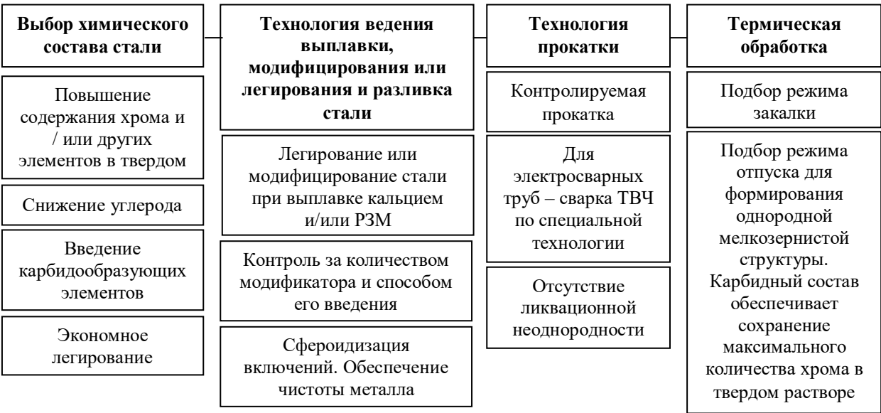
Рисунок 2 – Схема подхода к обеспечению требуемого уровня прочностных свойств нефтегазопроводных труб, лист 1
