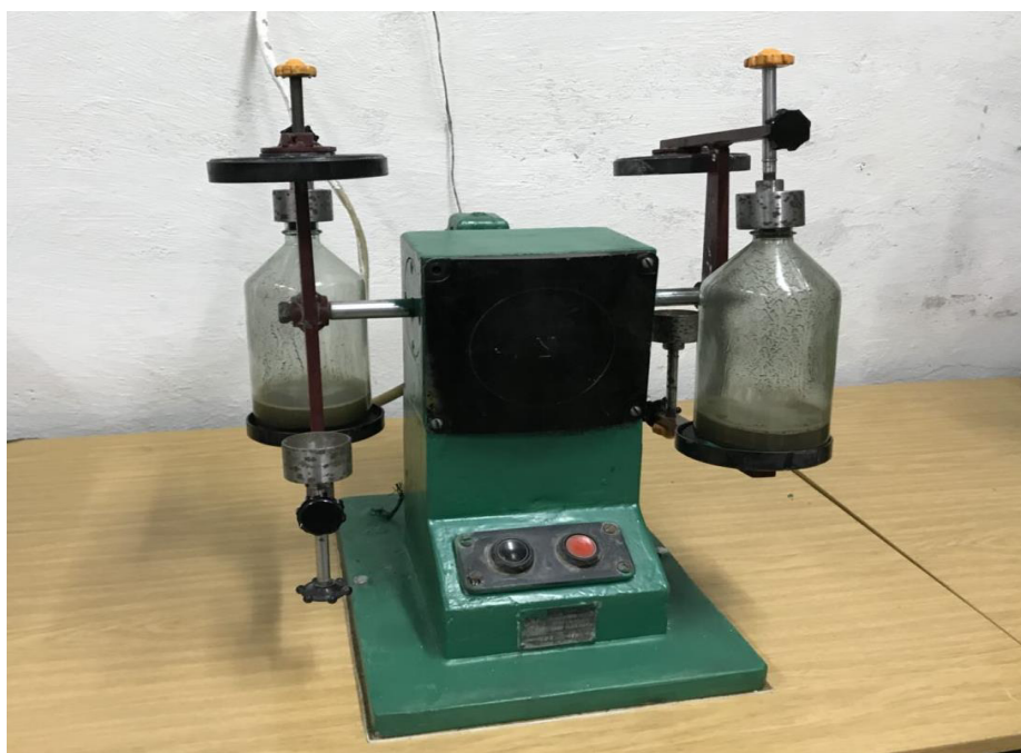
Рисунок 24 – Бутылочный агитатор для проведения выщелачивания гравитационного концентрата
