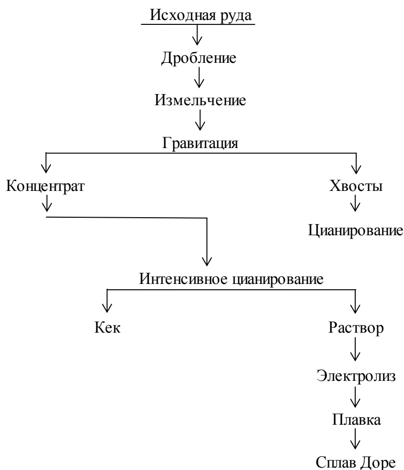
Рисунок 13 – Стандартная технологическая схема переработки золотосодержащей сульфидной руды
