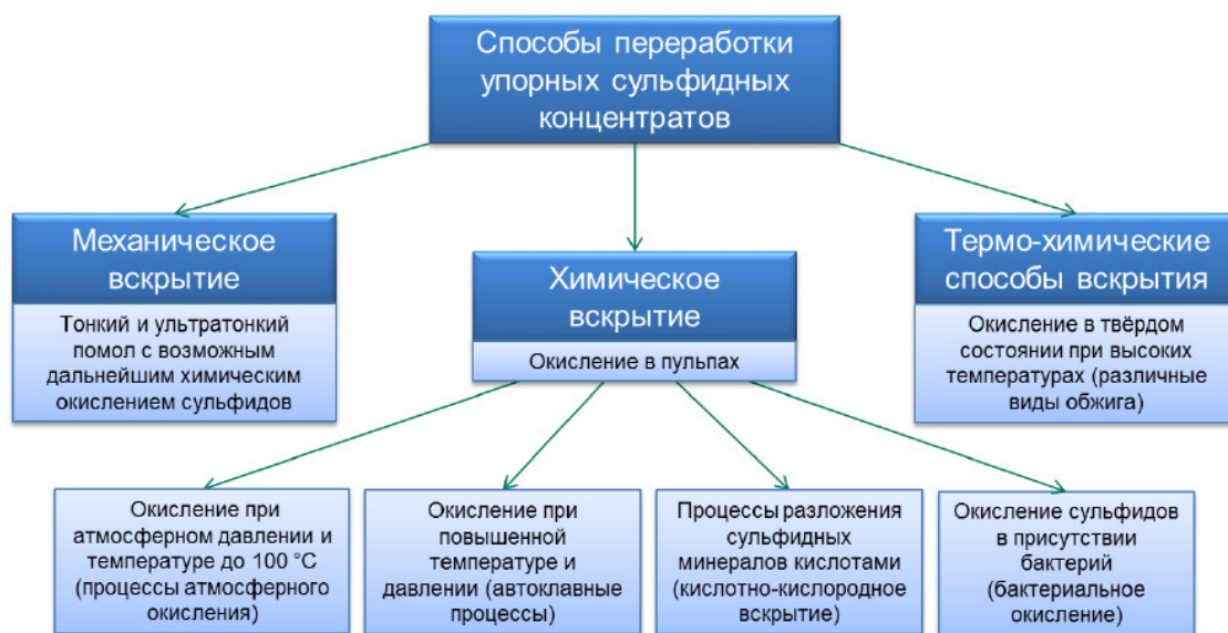
Рисунок 1 – Способы переработки упорных сульфидных гравитационных концентратов [66]
