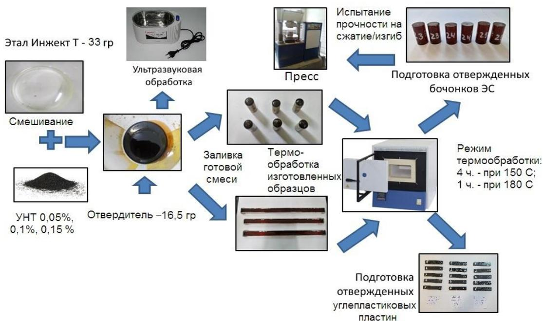
Рисунок 20 – Технологический процесс изготовления образцов ЭС с УНТ
