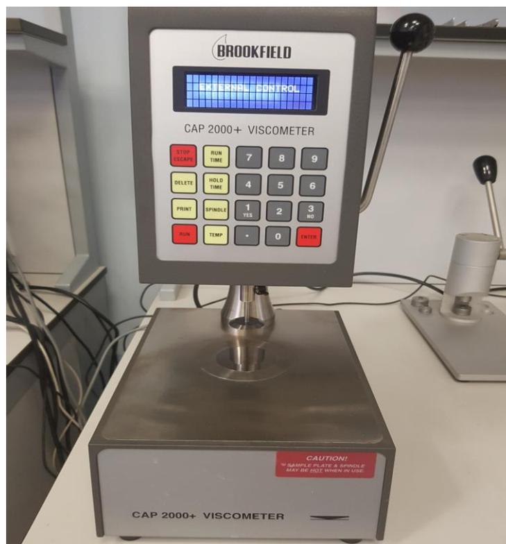
Рисунок В.3 –Ротационный вискозиметрBrookfield CAP 200+
