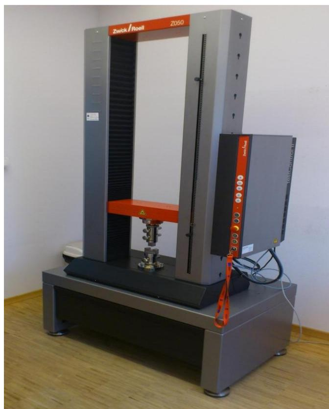
Рисунок В.6 – Электромеханическая испытательная машина Zwick/RoellZ050
