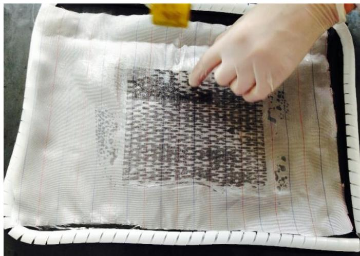
Рисунок 17 – Выкладка жертвенной ткани и распределительной сетки
