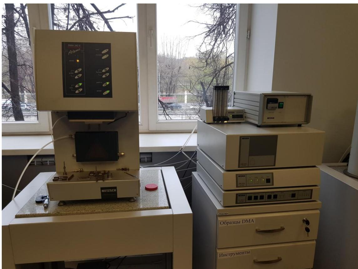
Рисунок В.4 – Динамический механический анализатор DMAArtemis 242
