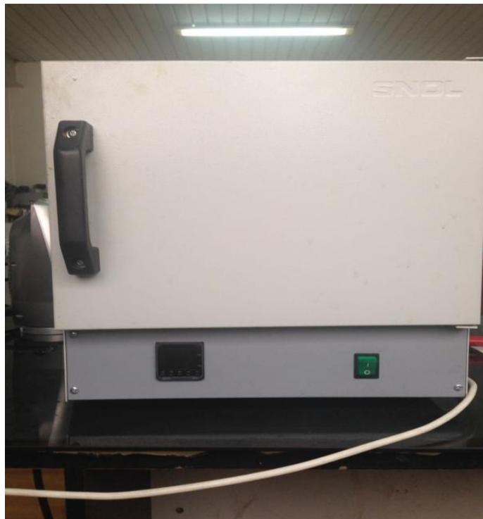
Рисунок В.2 – Сушильный шкаф для термообработки
