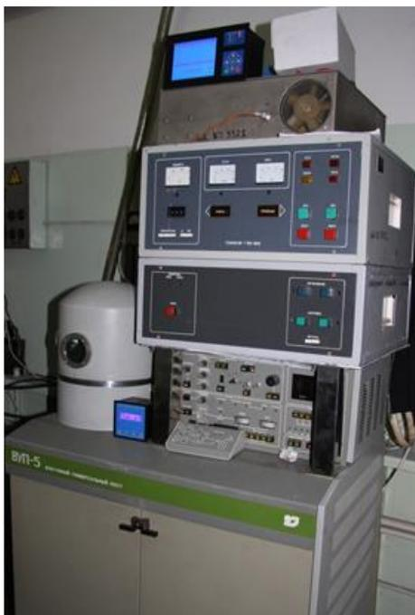
Рисунок 24 – Внешний вид оборудования для напыления КФ покрытий (ВУП-5) и источника питания распылительной системы
