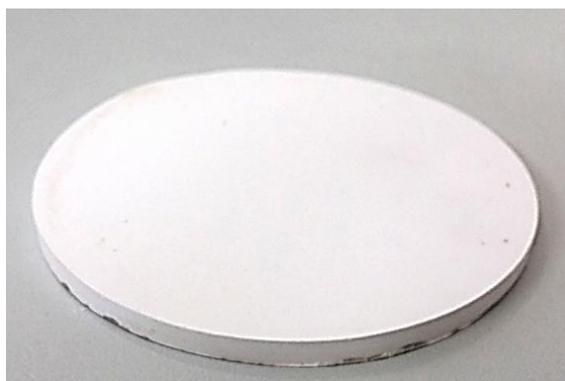
Рисунок 21 – Вид мишени из синтезированного порошка гидроксиапатита
