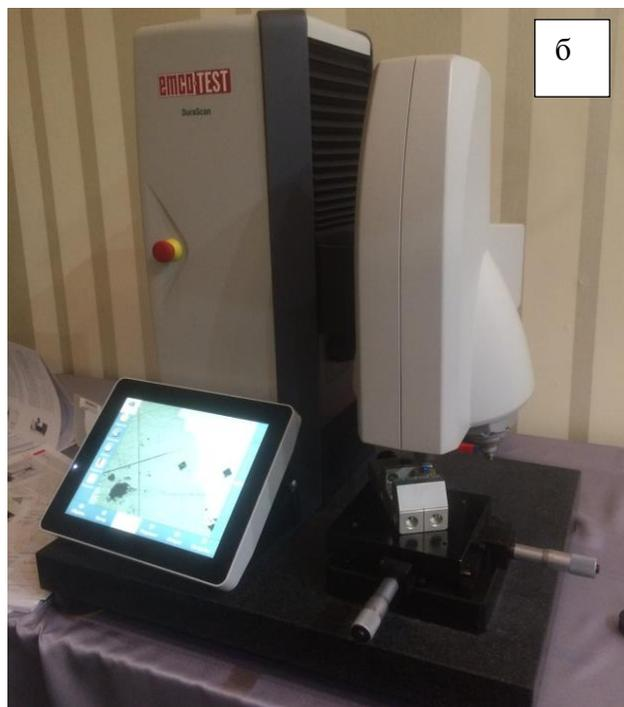
Рисунок 2.5 – Твердомеры ПМТ-3М (а) и DuraScan G5 (б).
