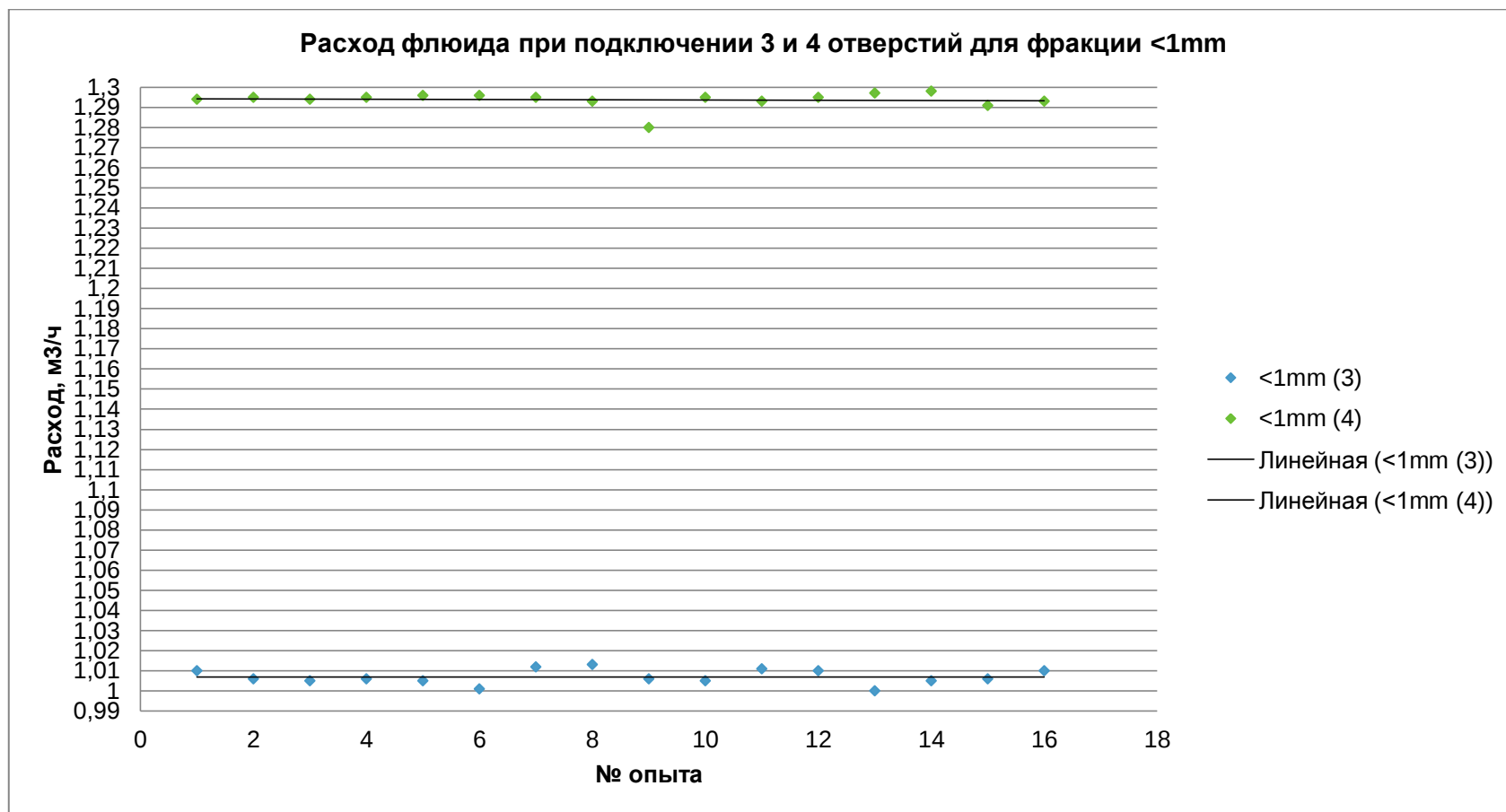
Рисунок 3.10 - Расход флюида при использовании трех и четырех отверстий для фракций песка меньше 1 мм
