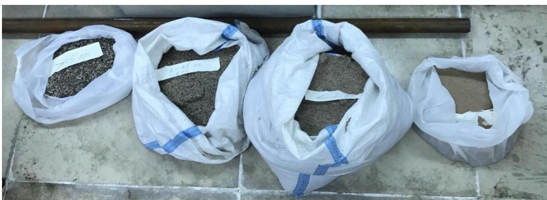
Рисунок 3.2 Речной песок, рассортированный по фракциям
