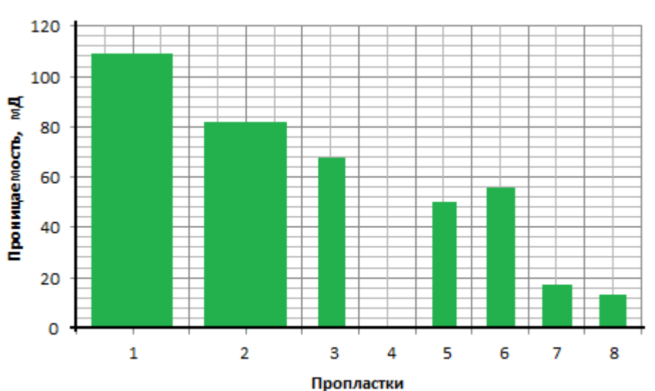
Рисунок 4.5 - Распределение проницаемостей продуктивного горизонта месторождения Узень для случая Е
