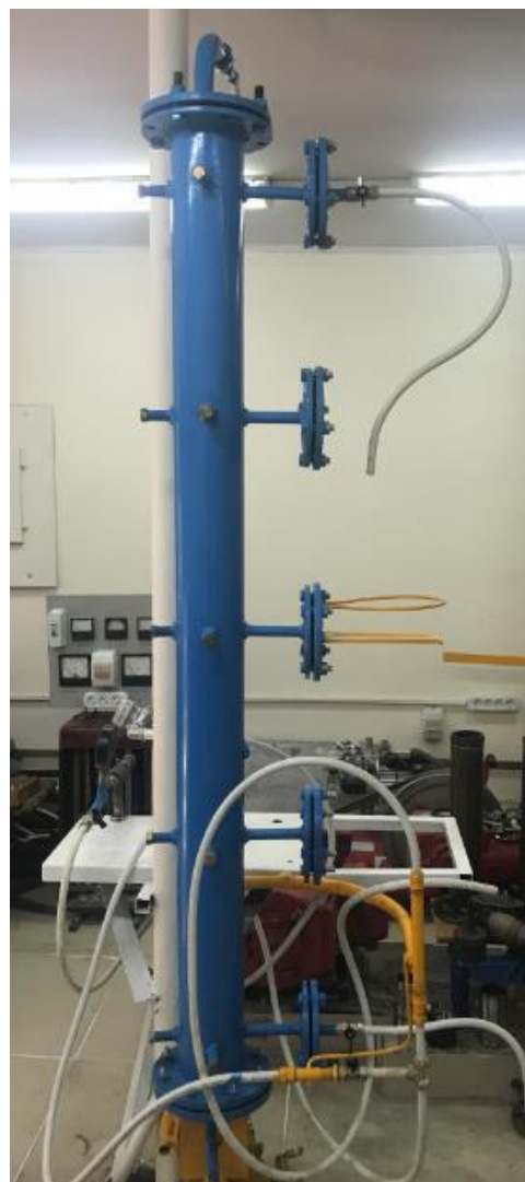
Рисунок 3.1 Экспериментальная установка для проведения опытов по равномерному профилю вытеснения нефти агентом
