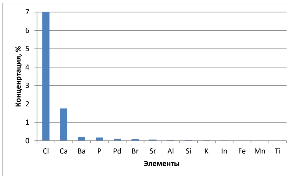
Рисунок 3.22 – Элементный состав пластовой воды с месторождения «Ащысай»
