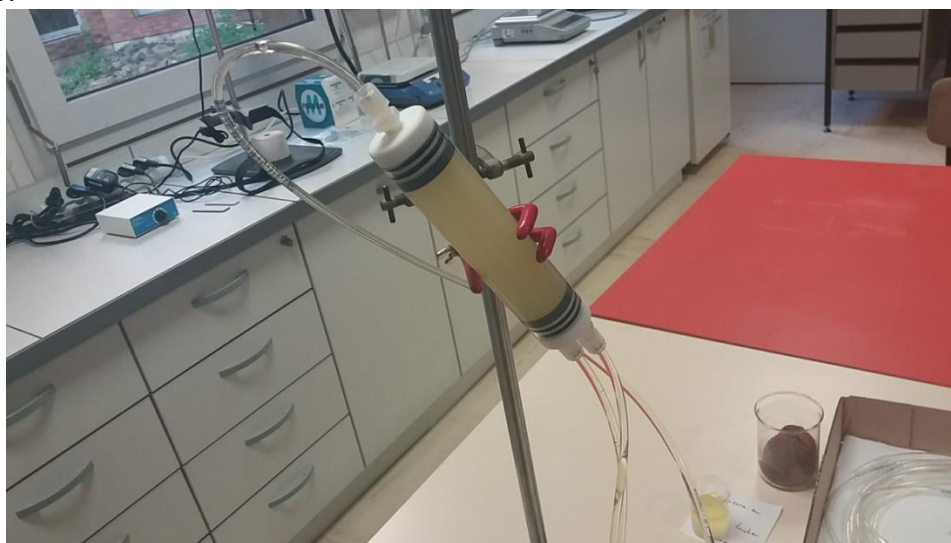
Рисунок 3.26 – Образец модели керна из пластиковых шариков
