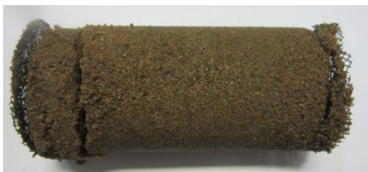
Рисунок 3.8 – Физическая модель керна
