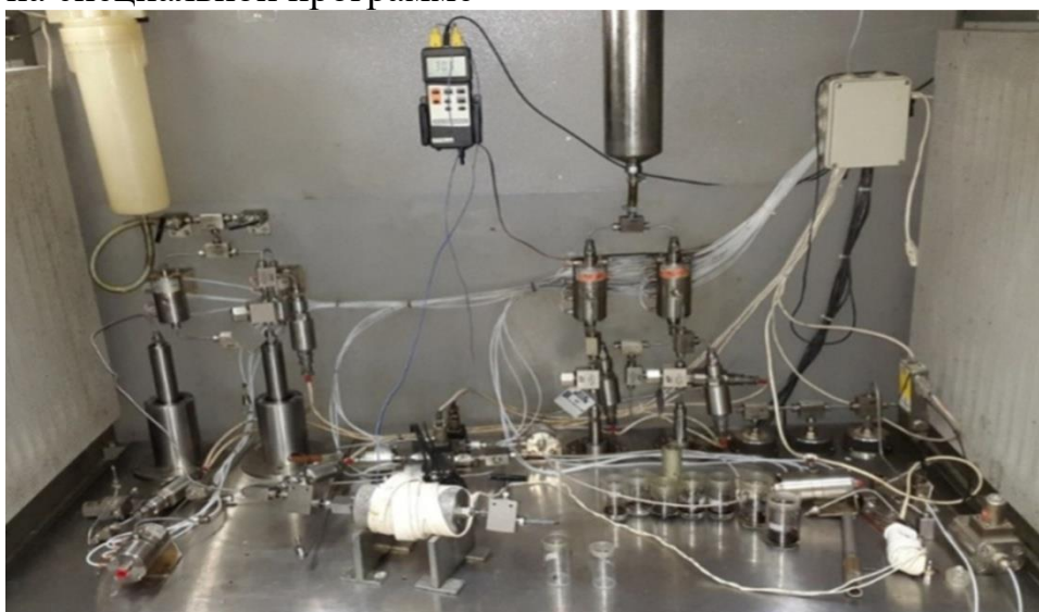
Рисунок 3.4 – Установка для исследования кернов УИК-С(2)
