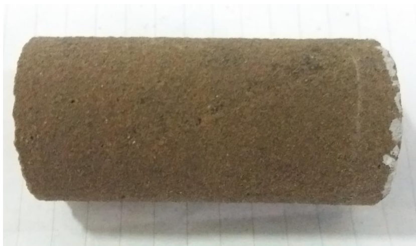
Рисунок 3.24 – Образец керна «Ащысай 2»
