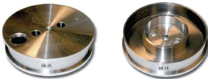
15сурет - Цемент тасының бойлық ұлғаю коэффициентін анықтауға арналған аспап [34,149].
