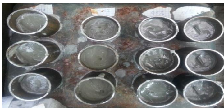
14-сурет. Цемент тасының шеген тізбегімен ілінісуін анықтауға арналған үлгілер
