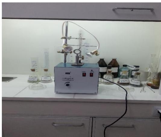
Рисунок 10 - Прибор ПТП (М) для определения температуры плавления парафина
