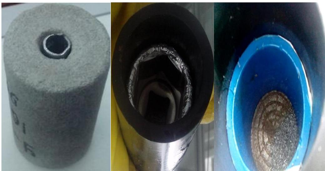
Рисунок 6- Установленная в керне металлическая трубка для подачи реагента Rau -85
