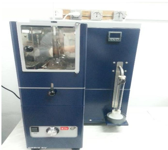
Рисунок 9- Аппарат атмосферной перегонки ORBISMOР
