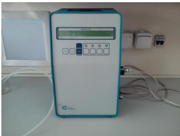
Рисунок 8 –Измеритель давления насыщенных паров нефтепродуктов
