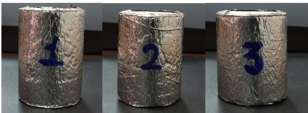
Рисунок 4 – Снимок подготовленного спрессованного кернового материала обернутого в никелевую фольгу
