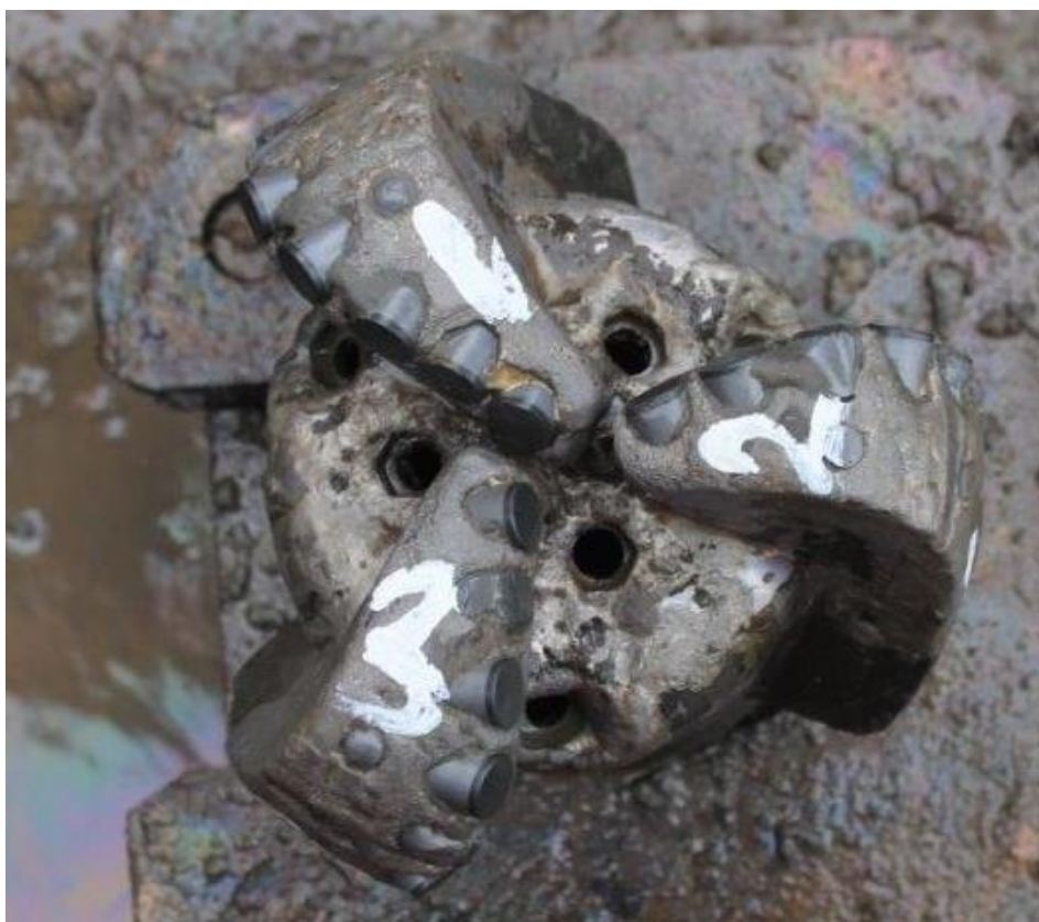
Рисунок 1 - Новое PDC долото (Казахстанского производства)
