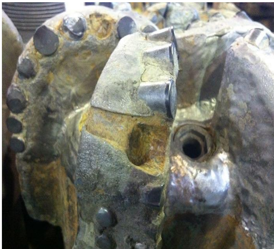
Рисунок 4 - Долото, пробуравившее третью скважину
