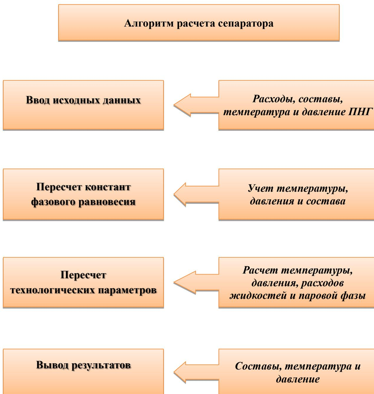
Рисунок 2.4 – Алгоритм расчета сепараторов (3-хфазных и 2-хфазных)
