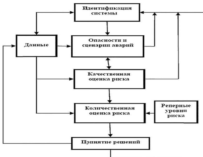
Рисунок 4.1- Алгоритм определения потенциальных опасностей
