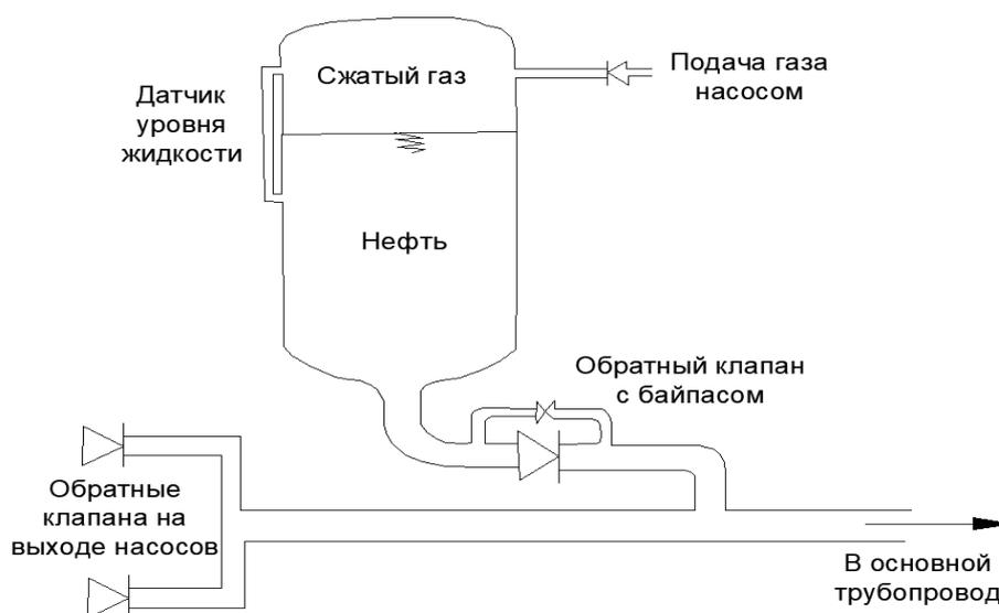
Рисунок 1.9 – Воздушный колпак на выходе перекачивающей станции
