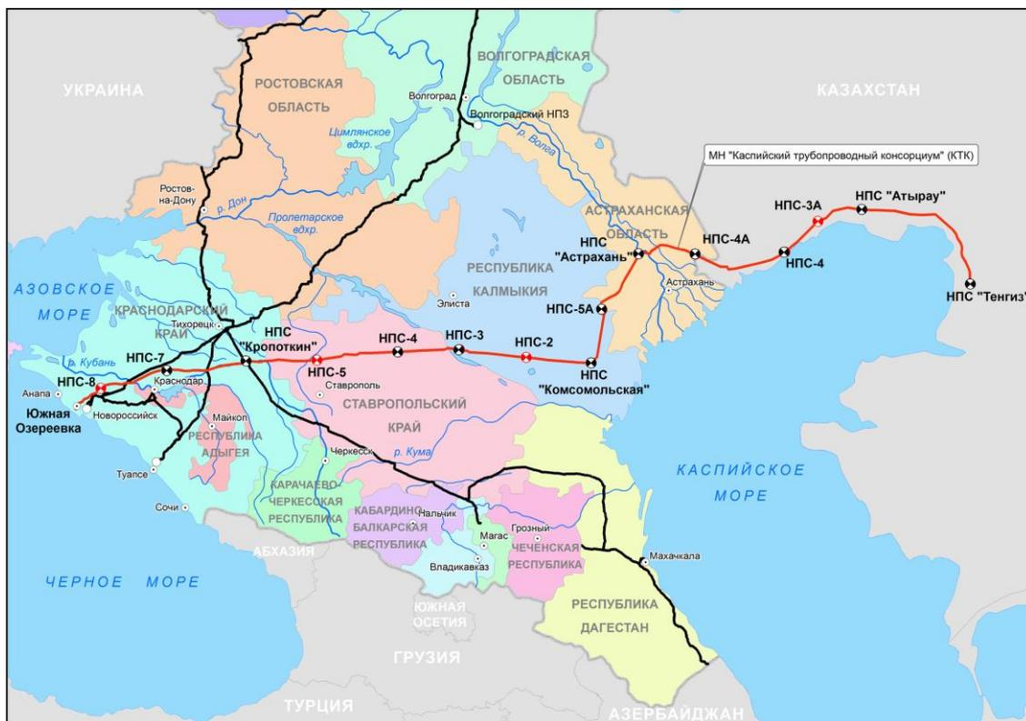
Рисунок 2.4 – Трасса магистрального нефтепровода Каспийского трубопроводного консорциума
