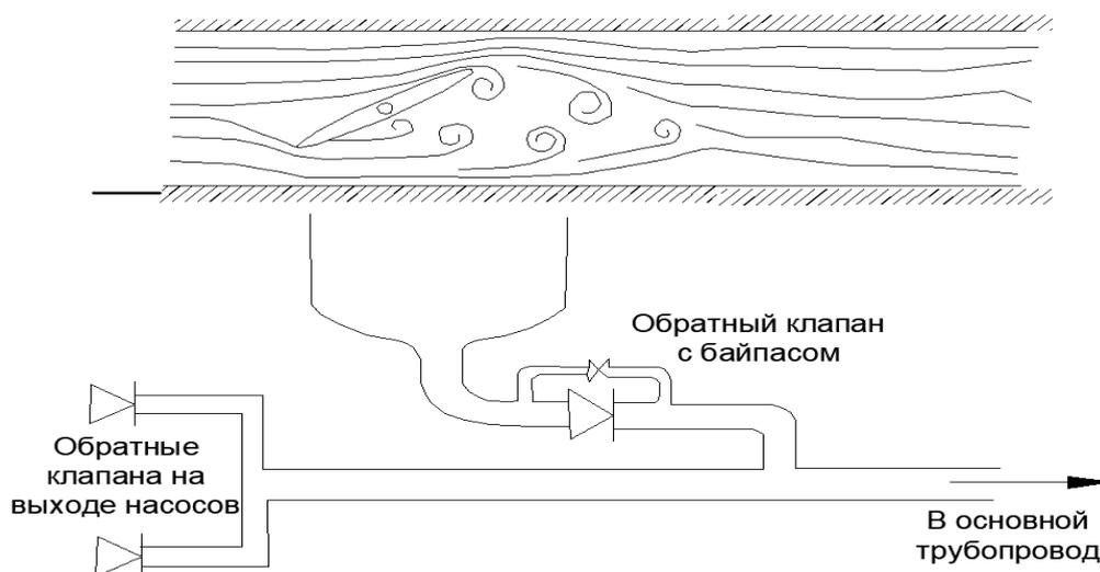
Рисунок 1.10 - Дросселирование потока жидкости в регулирующей заслонке типа « Butterfly».
