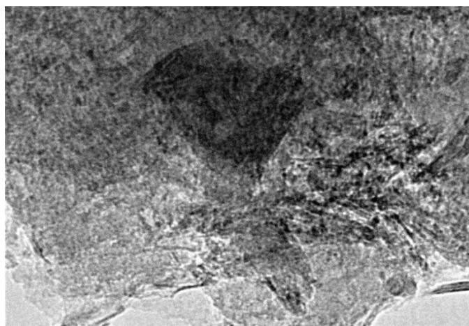
Рисунок 3.13 - Снимок ПЭМВР катализатора 0,35%Pd/NaHMM+ HM (увеличение 200000)
