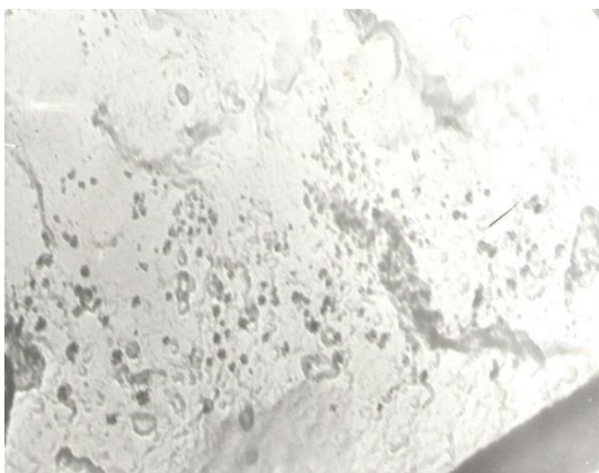
Рисунок 3.38 – Электронномикроскопический снимок 0,35%PdZ/AlZrCaHMM+HM катализатора (увеличение 50000)
