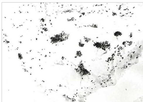
Рисунок 3.27 – Электронномикроскопические снимки катализаторов 0,35%Pd-золь/CaHMM (увеличение 78000)
