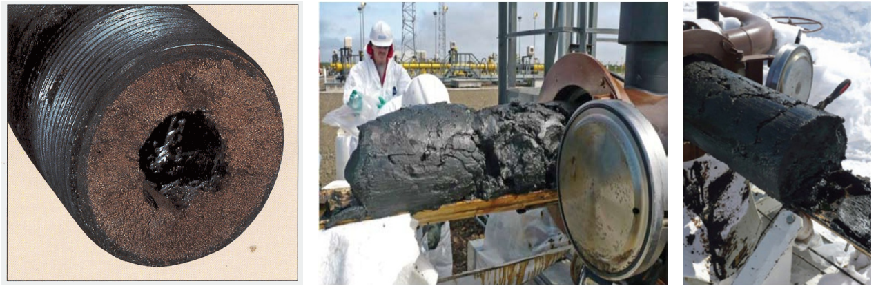
а – отложение АСПО на внутренних стенках НКТ; б и в – извлечение АСПО Рисунок 4 – Накопление АСПО в нефтепроводах
