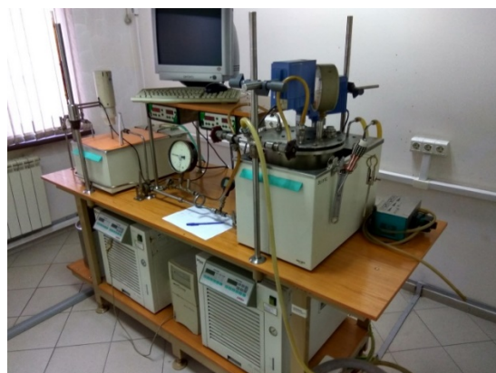
Рисунок 33 – Модельный стенд НТЦ АО «КазТрансОйл» для проведения испытаний присадок (депрессантов) в нефти/нефтепродуктов
