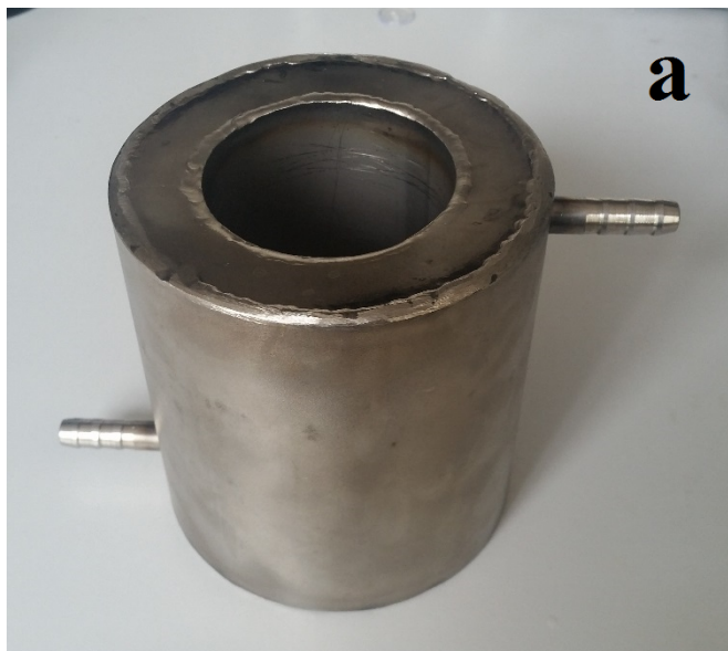
Рисунок 28 – Цилиндрический модельный резервуар (а) и схема его работы (б) для тестирования ингибирования парафиноотложения
