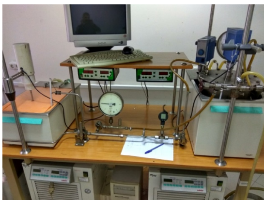
Рисунок 33 – Модельный стенд НТЦ АО «КазТрансОйл» для проведения испытаний присадок (депрессантов) в нефти/нефтепродуктов
