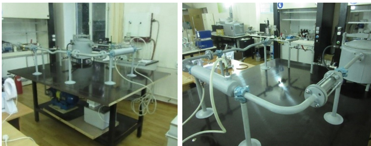
Рисунок 31 – Установка модельный нефтепровод
