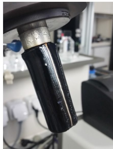
Рисунок 71 – Выделение АСПО из нефти на «холодном стержне»
