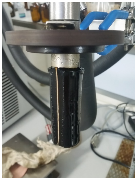
Рисунок 71 – Выделение АСПО из нефти на «холодном стержне»
