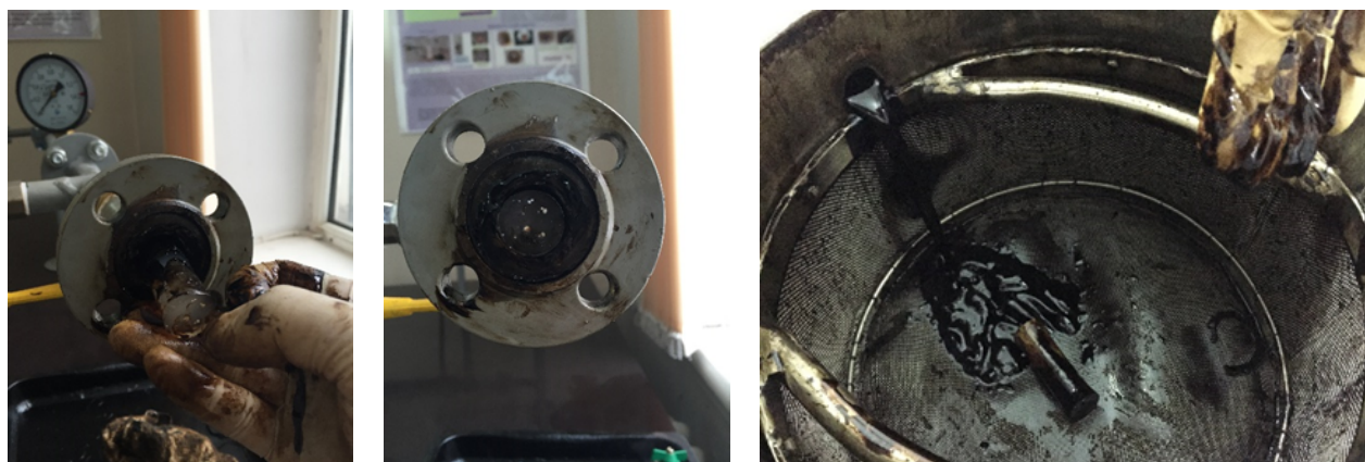
Рисунок 72 – Загрузка гидрогелевого «скребка» в камеру пуска модельного трубопровода и извлечение АСПО
