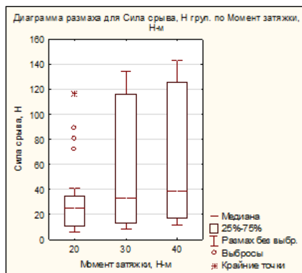
Рисунок 32 - Диаграмма размаха для силы срыва в зависимости от момента затяжки
