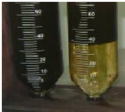
Рисунок 22 - Эффективность деземulgатора – полное разделение фаз в течение 10 минут после перемешивания
