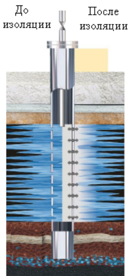
Рисунок 1.8 – Сравнительная схема закачки композиций на базе модифицированного жидкого стекла до и после проведения технологии [96].
