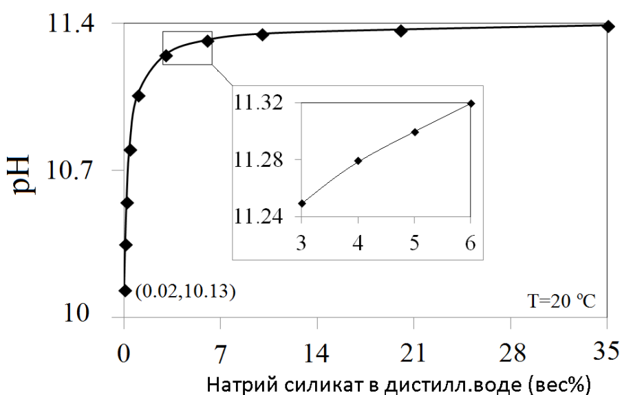
Рисунок 1.11– pH различных содержаний Na-силиката от 35 до 0,02 мас.% путем разбавления дистиллированной водой (DW) [107].
