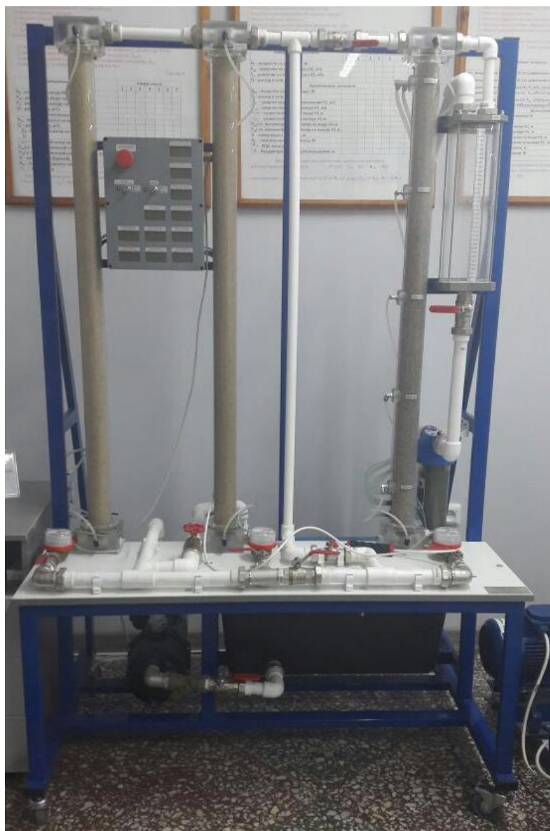
Сурет 3.1 - Мұнайлы қабат сегментінің өсі бойымен қысымның таралу сипаттамаларын ауыспалы шекаралық жағдайларда зерттеу қондырғысы
