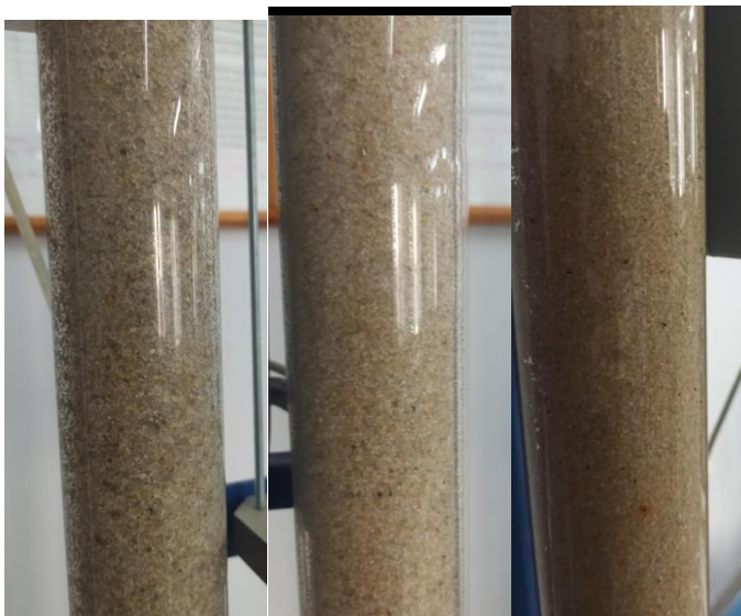
Сурет 3.2 - Әртүрлі өткізгіштік қасиеті бар жасанды кварц топырағы толтырылған цилиндрлік шыны контейнерлер
