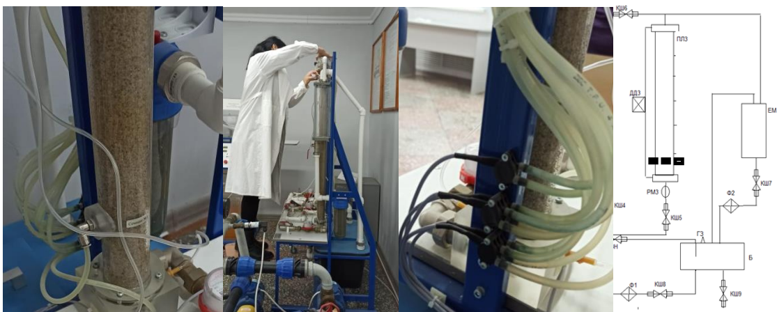
Сурет 3.20 - Забурунье кенорны Неоком-I және Неоком-II горизонттарынан керн үлгілерімен Қабат 3 ты толтыру, қабатты айналдыра датчиктер орналастыру жұмыстары
