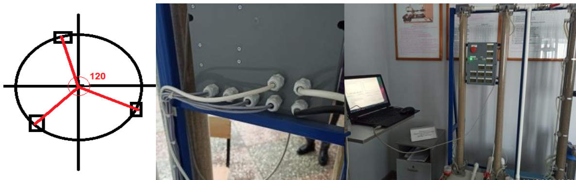
Сурет 3.21 - Датчиктердің орналасу схемасы
