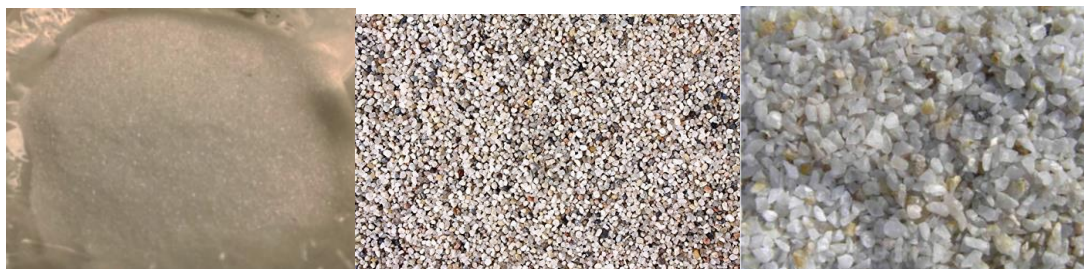
Сурет 3.8 - Қабат 1 , Қабат 2 , Қабат 3 қабаттарына арналған кварц құмы фракциялары
