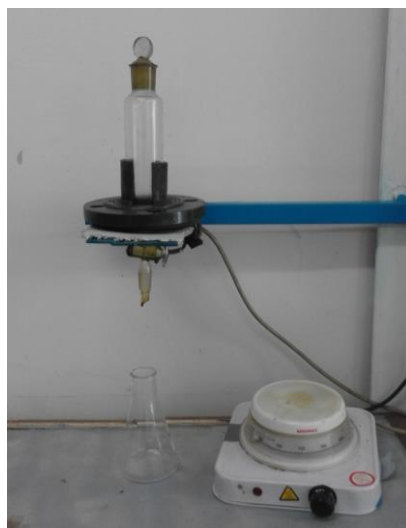
3.2-сурет. Мұнайдың тұтқырлығын анықтауға арналған құрылғы
