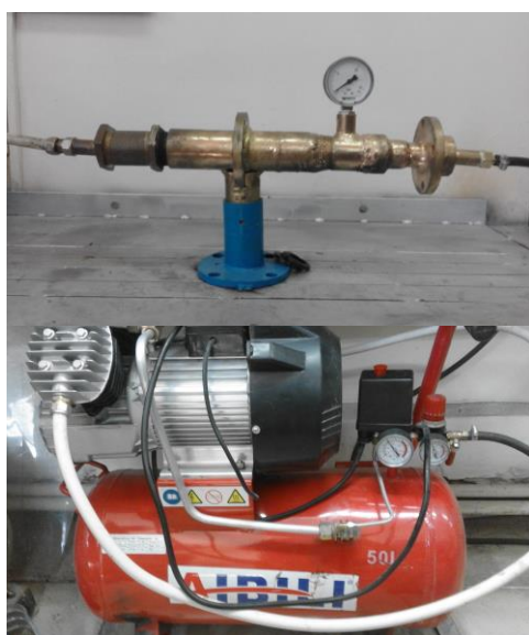
3.3-сурет. Керннің қуыстарындағы шаң-тозанды тазартуға арналған құрылғы
