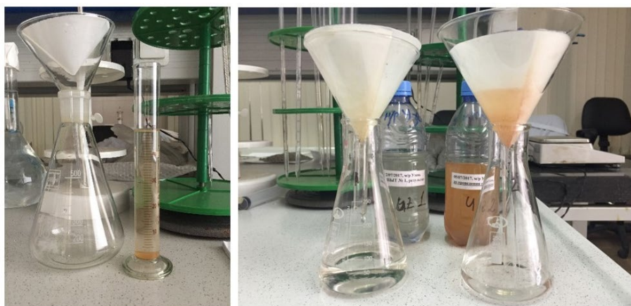
Рисунок 38 – Фильтрование пластовой воды на бумажном фильтре до и после очистки на Экспериментальной установке
