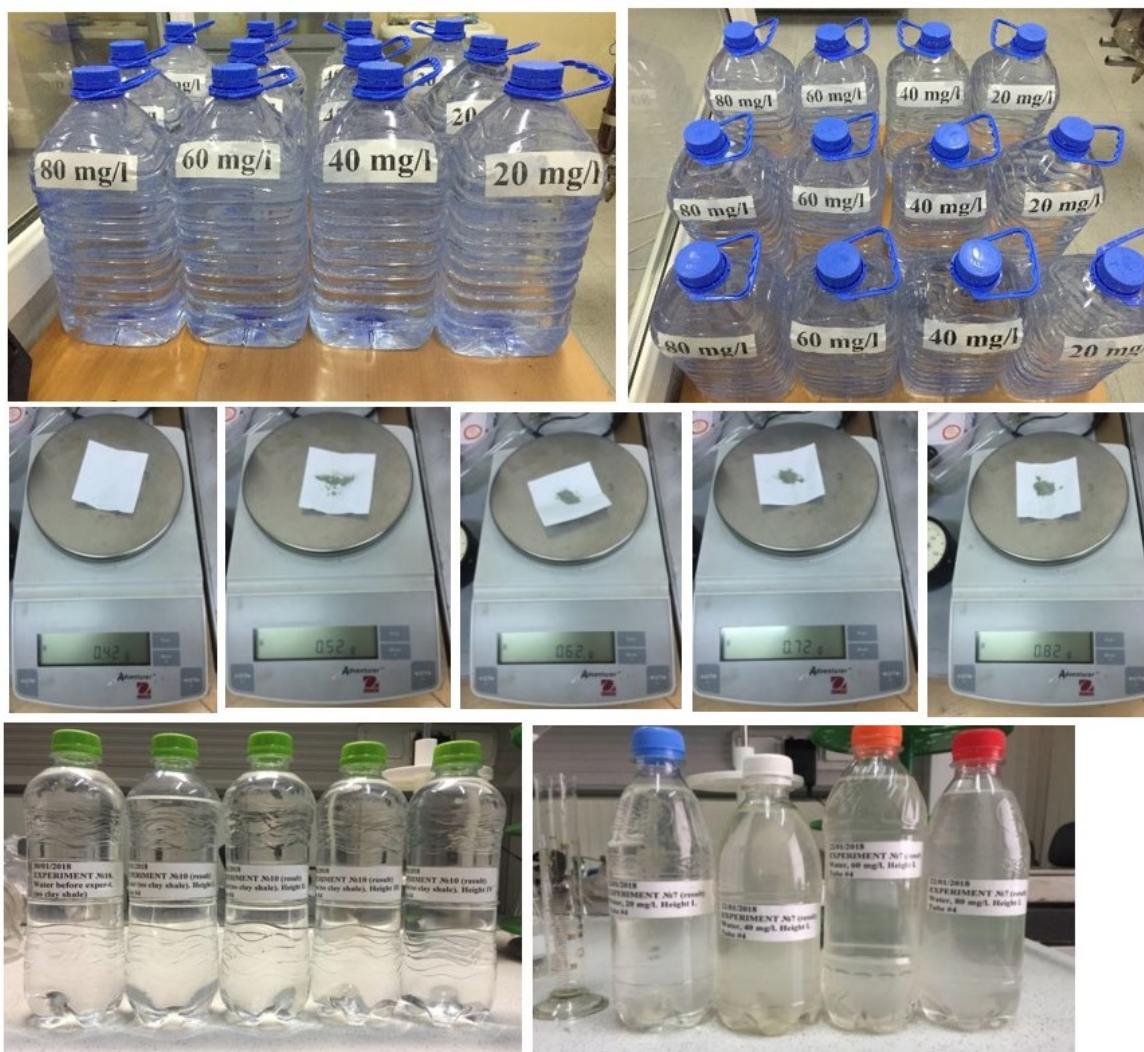
Рисунок 36 – вода с твердыми взвешенными глинистыми частицами до и после очистки по высоте рабочей зоны фильтра 10, 20, 30, 40 см
