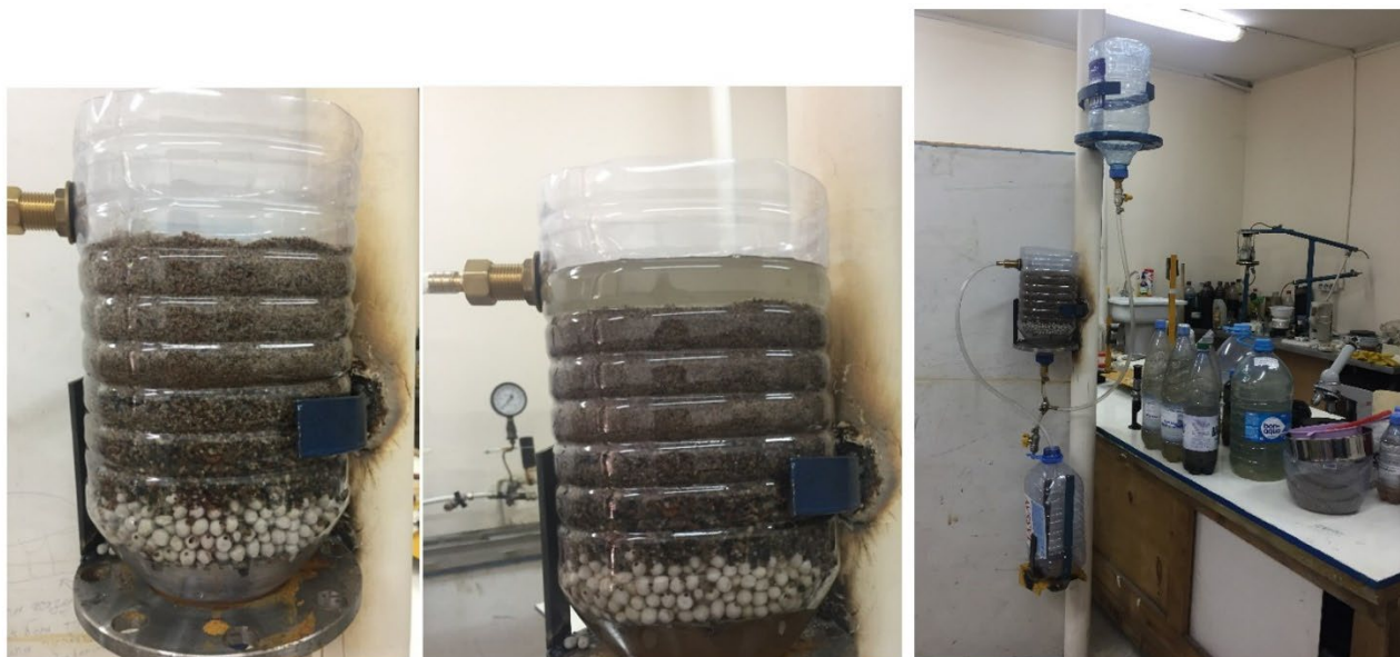
Рисунок 27 – Экспериментальная установка № 1, для очистки пластовой воды со взвешенными частицами
