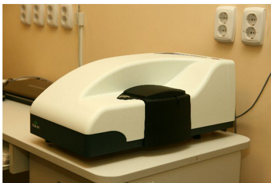
Рисунок 41 – Анализатор размеров частиц и молекул Malvern Zetasizer Nano ZS в лаборатории Инженерного профиля КазНИТУ им. К.И. Сатпаева
