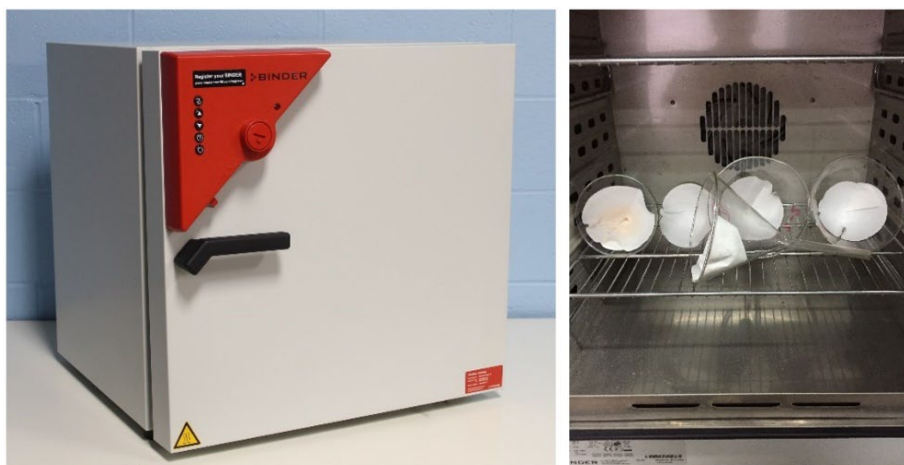
Рисунок 39 – Сушильный шкаф Binder FED53 в лаборатории Инженерного профиля КазНИТУ им. К.И. Сатпаева
