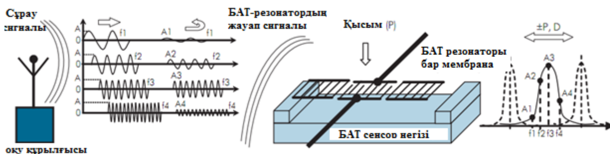
Сурет 1.20 - БАТ-құрылымды резонансты белсенділеудің радиоарналы тәсілі
