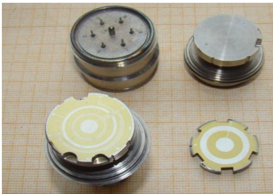
Сурет 4.13 - Қысым мен температураның сыйымдылық датчиктерінің құрамдас бөліктері: қабылдаушы элемент, сезімтал элемент және өлшеу модулі
