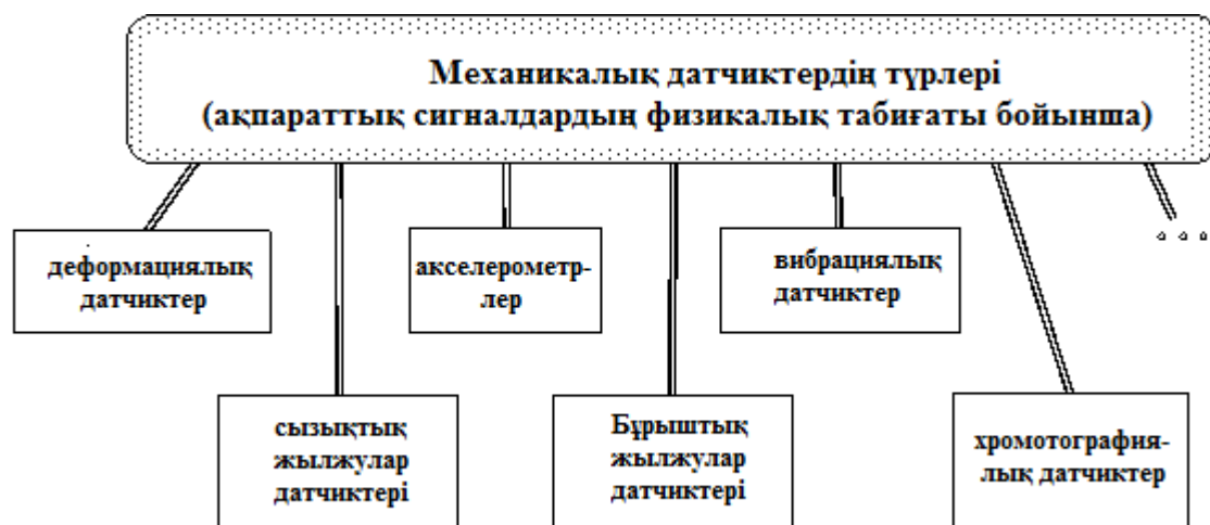
Сурет 1.11 - Механикалық датчиктердің ақпараттық сигналдардың физикалық табиғаты бойынша жіктелуі
