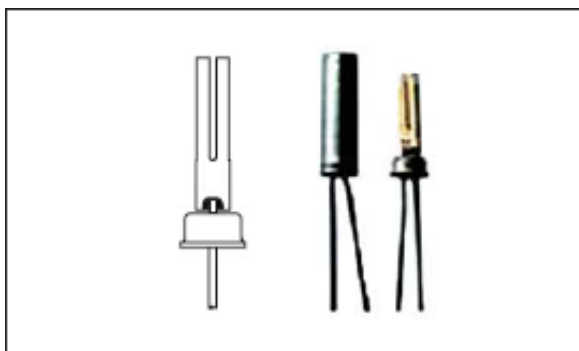
Сурет 1.16 - Кварцті термосезімтал резонаторлар РКТ206 және РКТВ206
