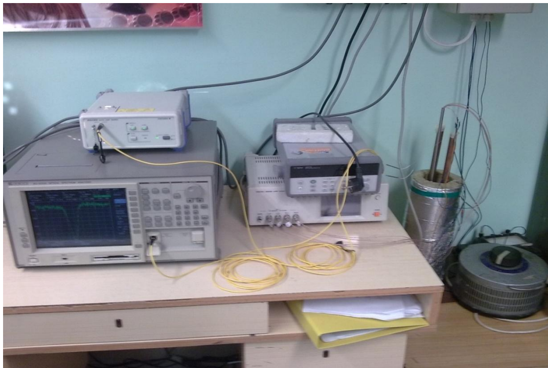
Сурет 3.12 - Брэгг торы сенсорының параметрлерін өлшеу станді
