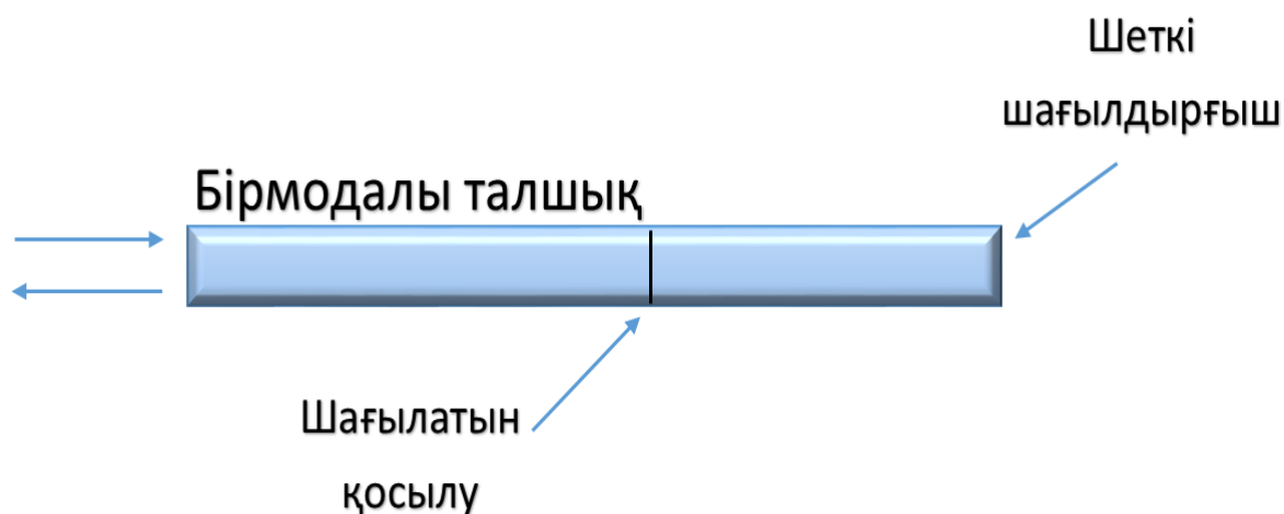
Сурет 3.5- Температураның талшықты сенсорының бір модальды интерферометрі
