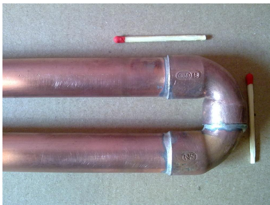
Сурет 3.15- Брэгг торы орналасқан зондтың салыстырмалы бейнесі
