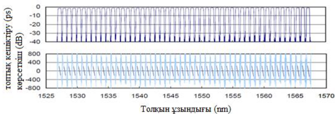
Сурет 3.37 – 100 км секцияның 51 арналарының дисперсиясын компенсациялауға арналған шағылысу спектрі (төмендегі) және топтық кідірісі (жоғарыда) ВБР мысалдары [34]
