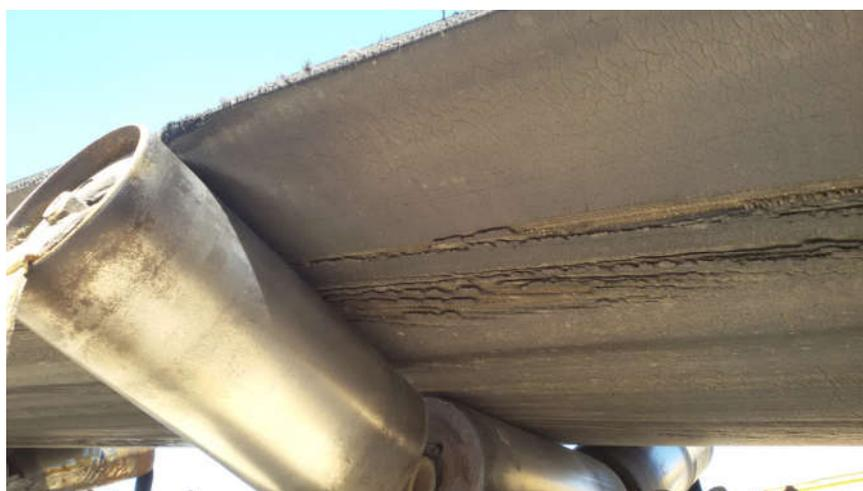
Рисунок 1.15 – Порезы на конвейерной ленте (на фото ленточный конвейер ТОО Семей Жолдары, транспортировка гравия)
