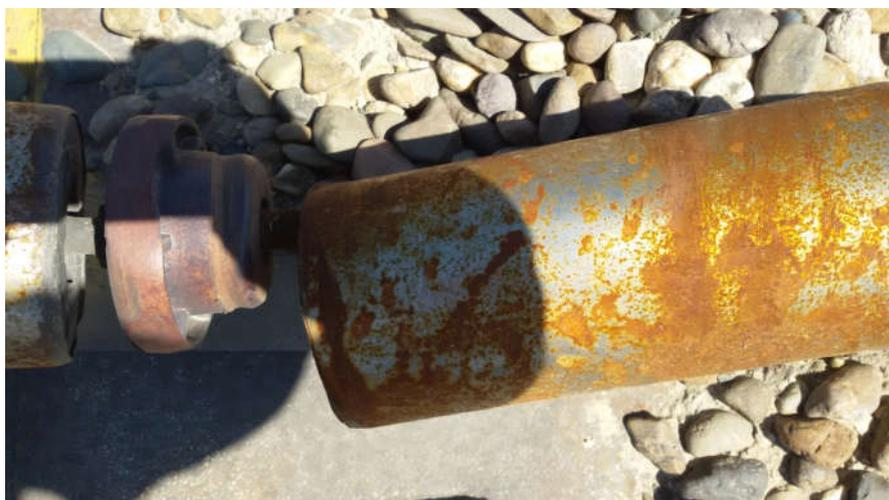
Рисунок 1.17 – Заклинивание подшипника конвейерного ролика с выдавливанием ступицы (ленточный конвейер ТОО Семей Жолдары, транспортировка гравия)
