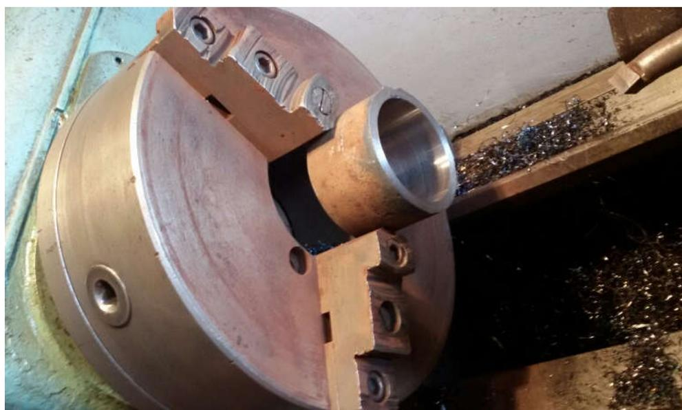
Рисунок 5.29 - Обработка образцов на станке 16K20
