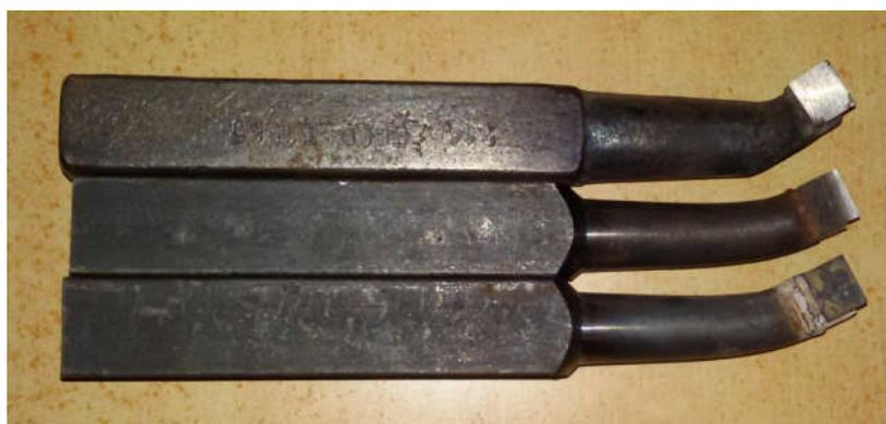
Рисунок 5.30- Расточные резцы, использованные для обработки
