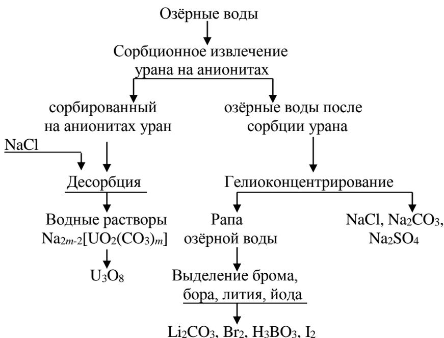
Рисунок 8 – Схема комплексной переработки минерализованных вод
