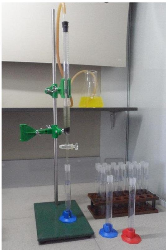
Рисунок 16 – Установка для снятия выходных кривых сорбции урана
