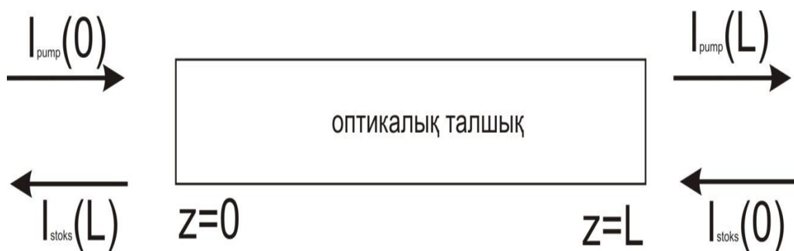
Сурет 4.3- Оптикалық талшық бойына енген сәулелердің шартты түрде белгіленуі
